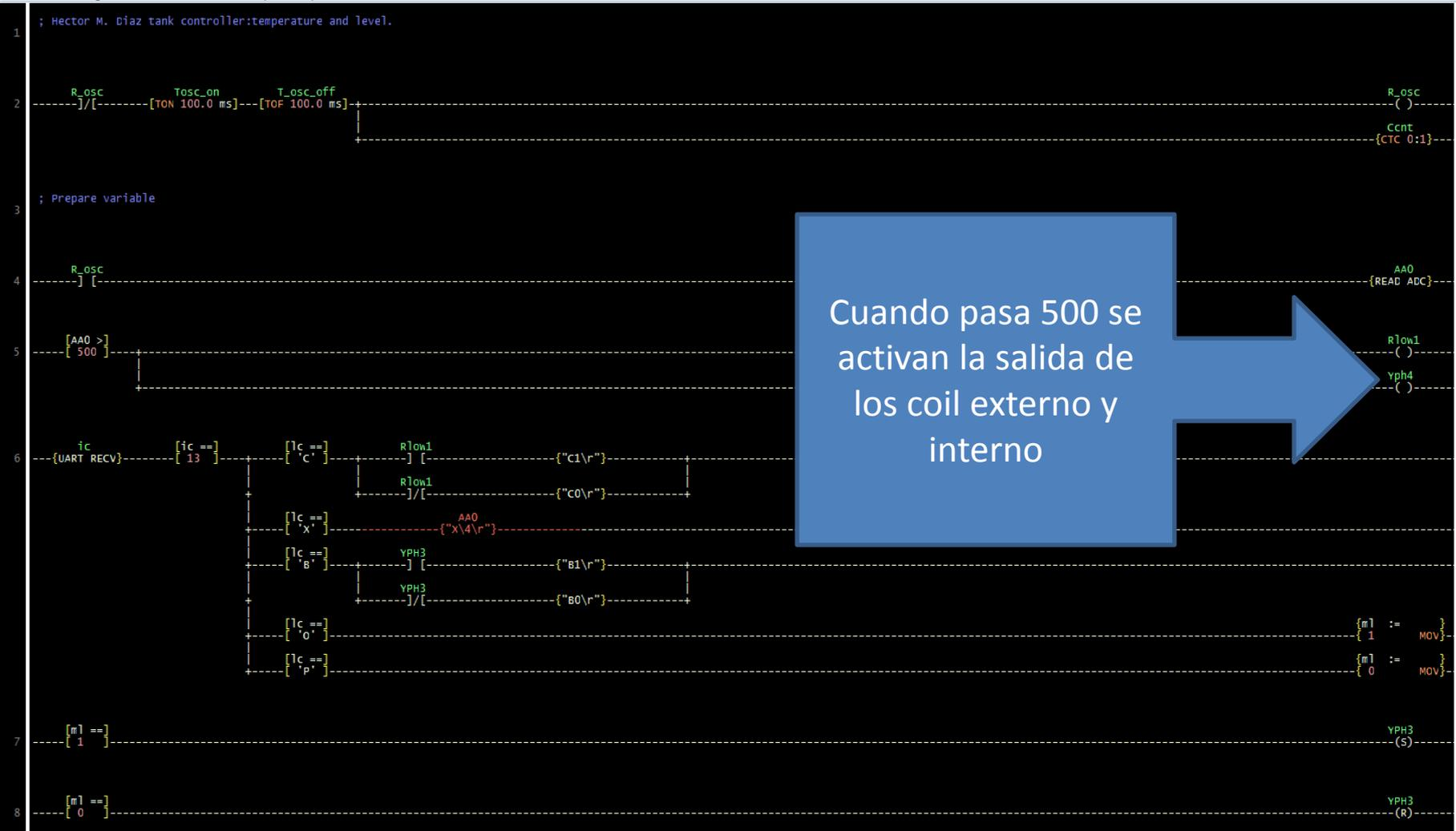
Quando pasa 500 se activan la salida de los coil externo y interno
